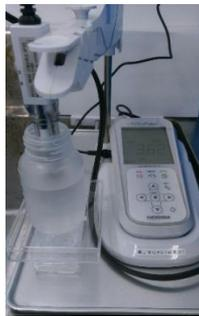
③電気伝導率メーターによる測定
